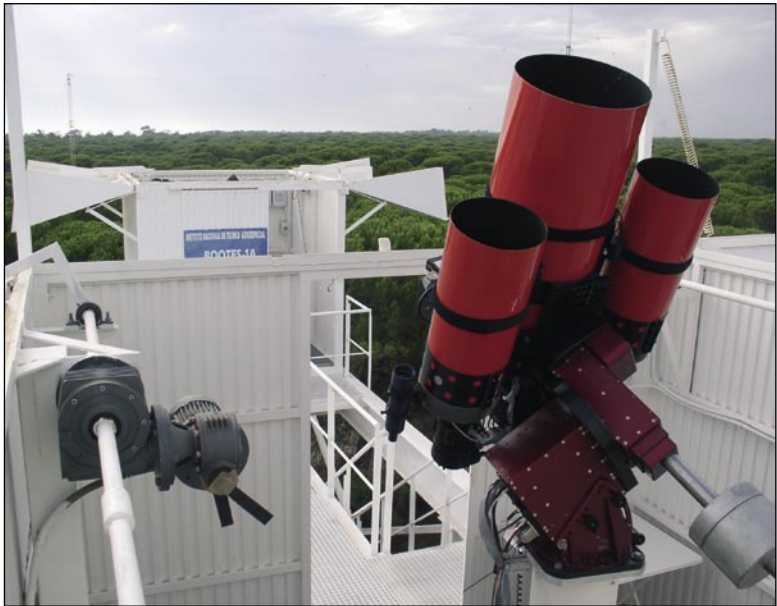
Estación robótica BOOTES-1 en el INTA, Mazagón (Huelva). En primer plano se encuentra el telescopio triple formado por instrumentos de 30, 20 y 20 cm de diámetro (uno de los cuales fue regalado por sus padres al autor de este artículo cuando tenía 16 años). La estación hermana (pequeña) es BOOTES-2 y está situada en la EELM-CSIC en Algarrobo Costa (Málaga).
